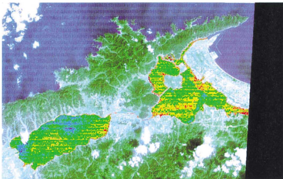
図7. Landsat-5/TM データから推定した宍道湖・中海の表層水温分布。低温で青く、高温ほど赤く示す。
